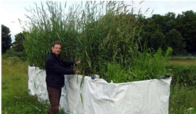
Dr. Ingo Dobner kontrolliert die Bepflanzung der neuartigen Filterversuchsanlage, mit der Arzneimittelreste in Kleinkläranlagen abgebaut werden sollen.
